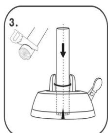
Dê ao tronco um corte reto e uniforme. Coloque o tronco no centro do suporte sobre o espião. Certifique-se de que o tronco e o espião tenham contato, mas não use força. Não faça furos no tronco.
